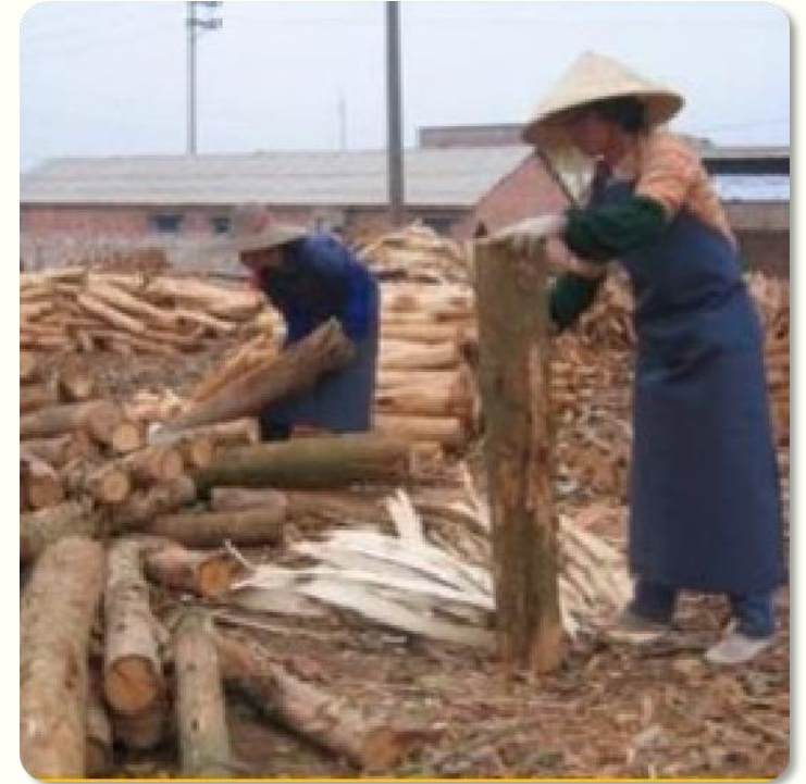
▲ Tukin kuorintaa vaneritehtaalla Kiinassa
